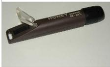
Un réfractomètre à main permet une meilleure évaluation de la teneur en eau d'un miel. Différents modèles existent dans le commerce. Certains modèles s'adaptent automatiquement à la température sans avoir à utiliser de tableaux de corrections.
