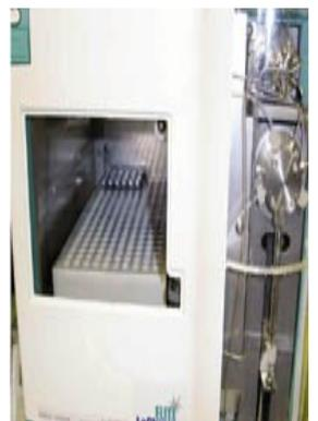
• Méthode de la Chromatographie Liquide Haute Performance (CLHP) Cette méthode (voir photo) est la plus utilisée actuellement car elle n'utilise pas de produit nocif et elle est la plus précise. Le miel en solution passe dans une colonne remplie de composés réactifs, qui sépare l'HMF. Un détecteur donne la valeur à la sortie de la colonne.
