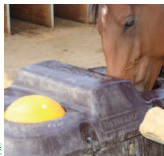
Abreuvoir automatique à niveau constant, maintenu par un système de réservoir avec flotteur, utilisé en extérieur.
