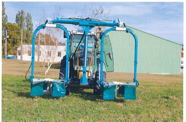
DHUGUES tunnel d'épamprage
