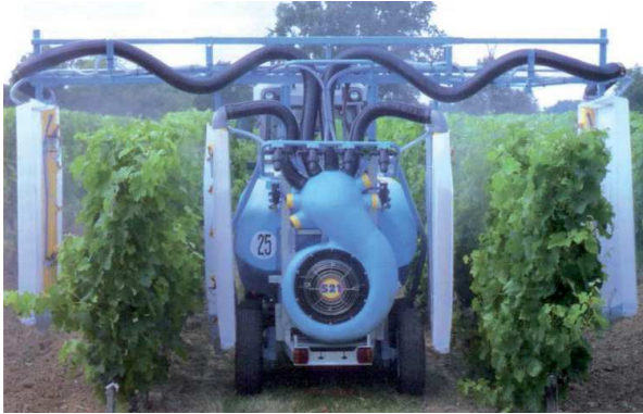
PULVERISATION S21 Tunnel de pulvérisation
