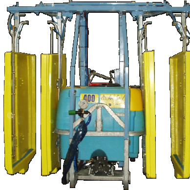
PULVERISATION S21 Panneaux récupérateurs
