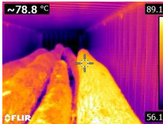
Figure 13 : intérieur du conteneur de peuplier après traitement vu par la caméra thermique
