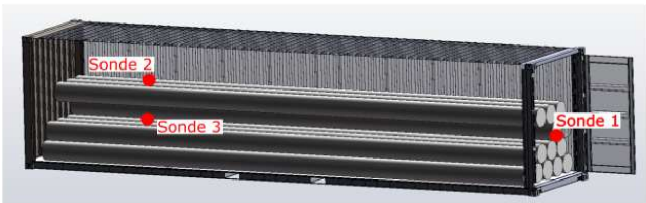
Figure 7 : position des sondes de T° dans le conteneur
