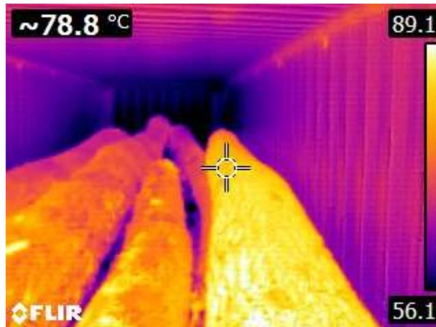
Figure 13 : intérieur du conteneur de peuplier après traitement vu par la caméra thermique
