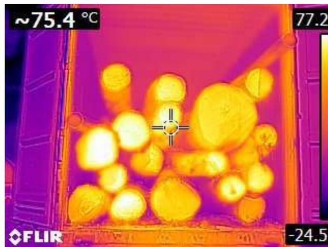
Figure 10: intérieur du conteneur de chêne après traitement thermique
