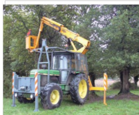
Prélèvement en hauteur à l'aide de nacelle
