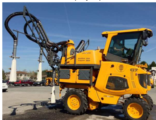
GREGOIRE - Multi Flow Progress avec rampe jet porté
