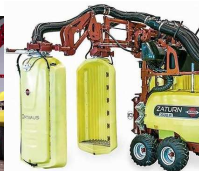
HARDI - panneaux récupérateurs OPTIMUS
