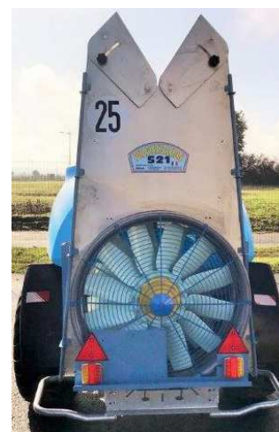
S21 – Double turbine vergers voûte droite
