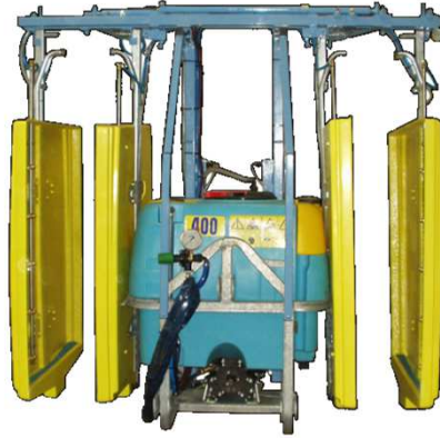
S21 - Panneaux récupérateurs
