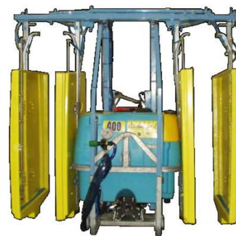
S21 - Panneaux récupérateurs
