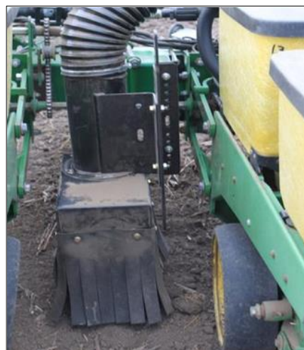
Boîte d'expansion en extrémité de tuyau et poils pour casser le flux d'air
