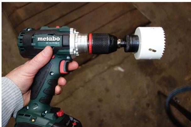
Utiliser une scie cloche, d'un diamètre minimal de 7 cm.
