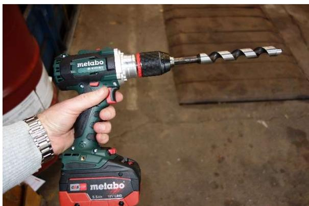
Utiliser une perceuse d'une puissance suffisante et des mèches à bois de diamètre supérieur à 20 mm de préférence. **Veiller à prélever les copeaux sans qu'ils ne chauffent.**
