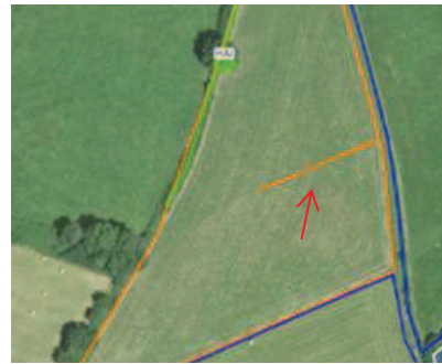
Erreur de géométrie : rebroussement (« fil » qui rentre dans l'îlot) qui doit être supprimé
