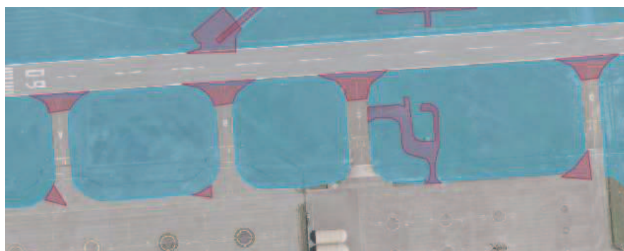
Les surfaces artificialisées présentes dans l'îlot ont été dessinées avec des petites-SNA de surface aménagée. Il aurait été préférable de saisir la piste dans sa totalité et non de multiples petites SNA.
