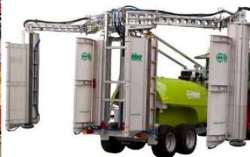
WEBER – descentes avec panneaux récupérateurs
