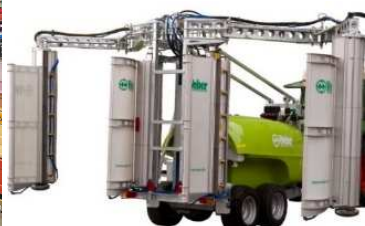
WEBER – descentes avec panneaux récupérateurs
