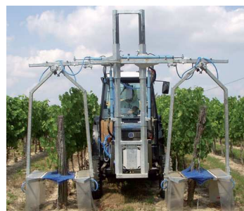
S21 - tunnel d'épamprage
