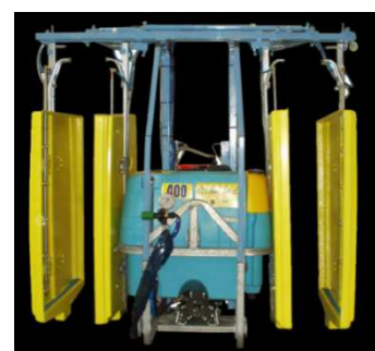
S21 - Panneaux récupérateurs
