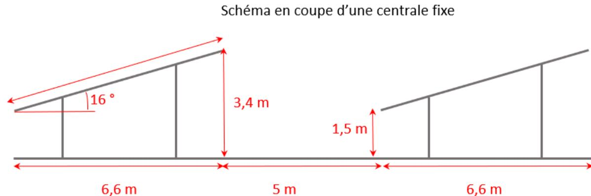
*La valeur de l'inclinaison des panneaux constitue un exemple et en aucun cas une recommandation*
