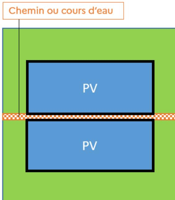
Cas 4 : deux parcelles agricoles à considérer au titre du R. 314-18, car séparées par un obstacle physique traversant l'installation agrivoltaïque de part en part
