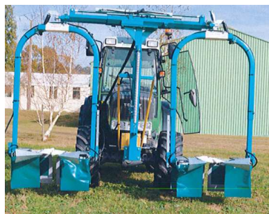
DHUGUES - tunnel d'épamprage
