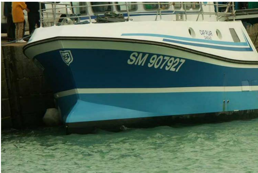
Bulbe situé au niveau la ligne de flottaison permettant d'augmenter la longueur
