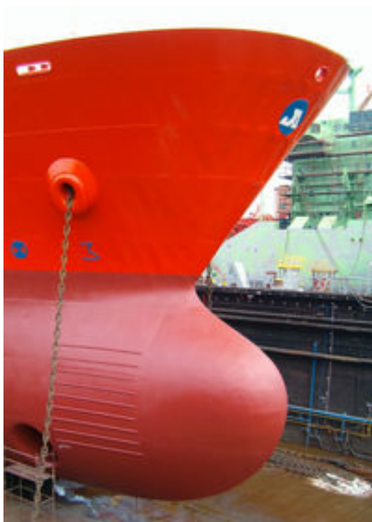
Bulbe d'étrave permettant de diminuer la résistance de vague
