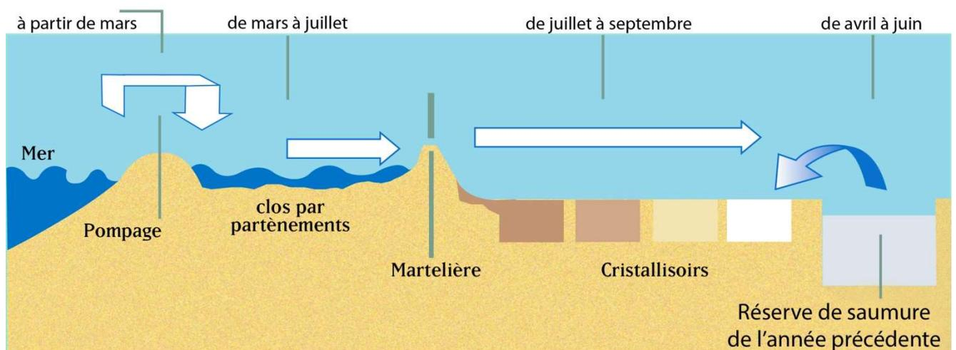
**SCHEMA DE PRINCIPE D'UN SALIN**
