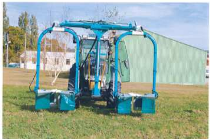
DHUGUES tunnel d'épamprage
