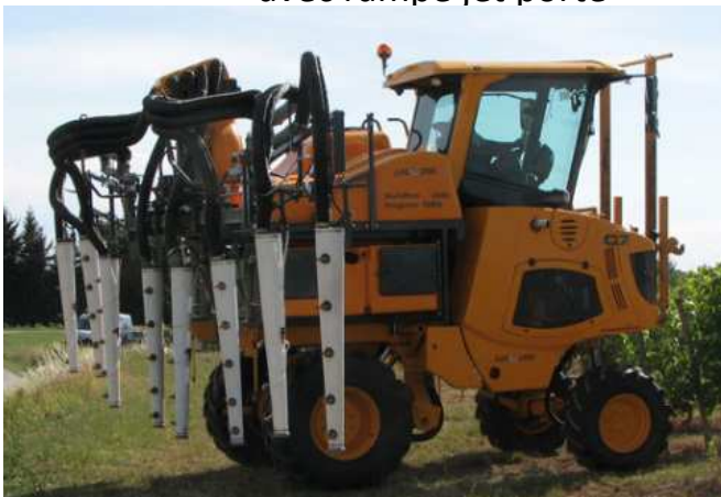
GREGOIRE ISO OPTIMA/ULTIMA avec rampe jet porté
