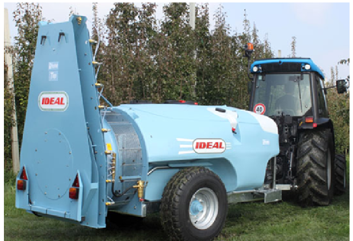
S21 Rampe flux tangentiel
