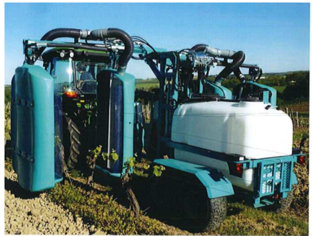
GREGOIRE Ecoprotect avec rampe jet porté
