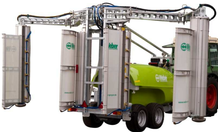
WEBER – descentes avec panneaux récupérateurs
