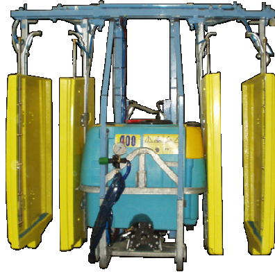
S21 - Panneaux récupérateurs
