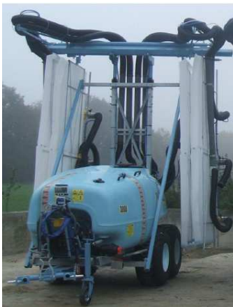
S21 – Tunnel de pulvérisation
