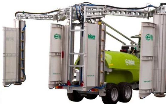
WEBER - descentes avec panneaux récupérateurs
