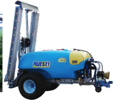
S21 - Turbine tangentielle
