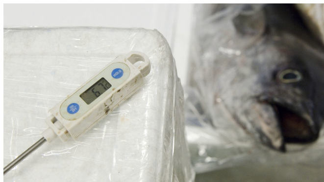
Le thermomètre à sonde permet de mesurer la température à cœur du produit, ici non-conforme : la température du poisson ne doit pas dépasser + 2 °C.
