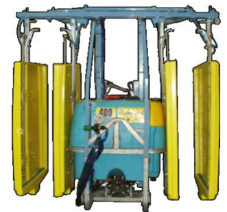
S21 - Panneaux récupérateurs
